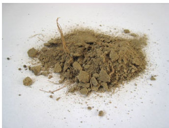
再利用する為掻き落した上塗土壁
