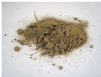
再利用する為掻き落した上塗土壁
